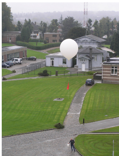
Figuur 2.11. Lancering van een meteorologische ballon met ozonsensor te Ukkel.
